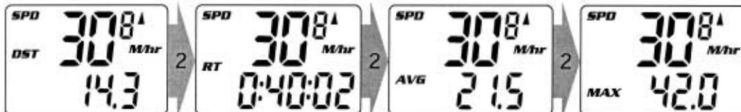
Вы можете запомнить показываемые на экране значения расстояния, времени поездки, средней скорости, максимальной скорости, нажав в любой момент Клавишу #1 на две секунды в режимах экрана SPD/DST или SPD/RT. Дисплей начнет мигать, показывая, что значение сохранено. Сохраненные данные можно просматривать, нажимая Клавишу #2. Нажмите Клавишу #1 для возврата в режим экрана DST или RT.
