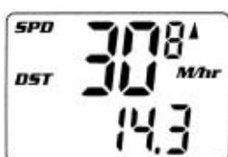
В этом режиме показывается расстояние, пройденное во время одной данной поездки с максимальным значением 999.9 миль или километров (с точностью 0.1 миль/км). Для сброса значения DST (+ MAX, AVG, RT, AVG/CAD, MAX/CAD) до нуля нажмите и одновременно удерживайте Клавиши #1 и #2 в течение 2 секунд в режиме экрана SPD/DST
