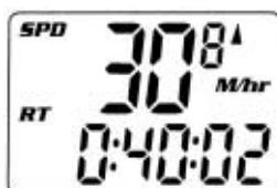
В этом режиме показывается суммарное значение времени поездки с максимумом 9 часов 59 минут 59 секунд. Для сброса на ноль вручную нажмите и одновременно удерживайте Клавиши #1 и #2 в течение 2 секунд в режиме экрана SPD/DST.
