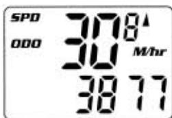
Одометр показывает пройденное расстояние до 99999 миль или километров (с точностью 1.0 миль/км). Настройка одометра производится в режиме установки (Setup) компьютера. Замечание: помните о выборе единиц измерения для одометра (он производится в режиме установки (Setup) компьютера). (Для смены единиц измерения нажмите и одновременно удерживайте в режиме экрана SPD/ODO Клавиши #1 и #2 в течение 2 секунд, пока не начнет мигать индикатор единицы измерения скорости/расстояния.)
