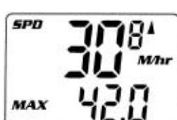
В режиме экрана SPD/AVG показывается средняя скорость с точностью до 0.1 миль или километров в час. Для сброса на ноль вручную нажмите и одновременно удерживайте Клавиши #1 и #2 в течение 2 секунд в режиме экрана SPD/DST
