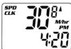
По выбору пользователя время показывается в 12- или 24-часовом формате. (Для изменения формата CLK (установки часов), времени или интервала технического обслуживания, нажмите и одновременно удерживайте Клавиши #1 и #2 в течение 2 секунд в режиме экрана SPD/CLK до тех пор, пока не появится мигающее изображение формата "12/24".)
