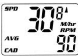
Индикация среднего каденса (педаляжа) выполняется в режиме экрана AVG/CAD и получается путем деления полного числа оборотов педалей за время движения. Для обнуления показаний среднего каденса (педаляжа) нажмите и одновременно удерживайте Клавиши #1 и #2 в течение 2 секунд в режиме экрана SPD/DST.
